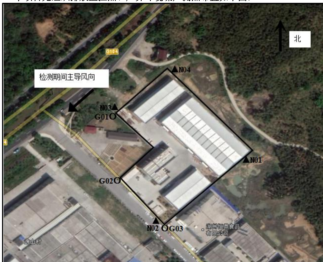
图3-3 本项目废气无组织排放监控点布置
