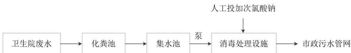
图 1-1 现有项目废水处理流程图
