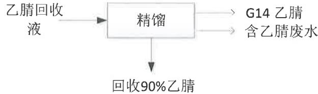
图 3-6 乙醇、乙腈回收工艺流程
