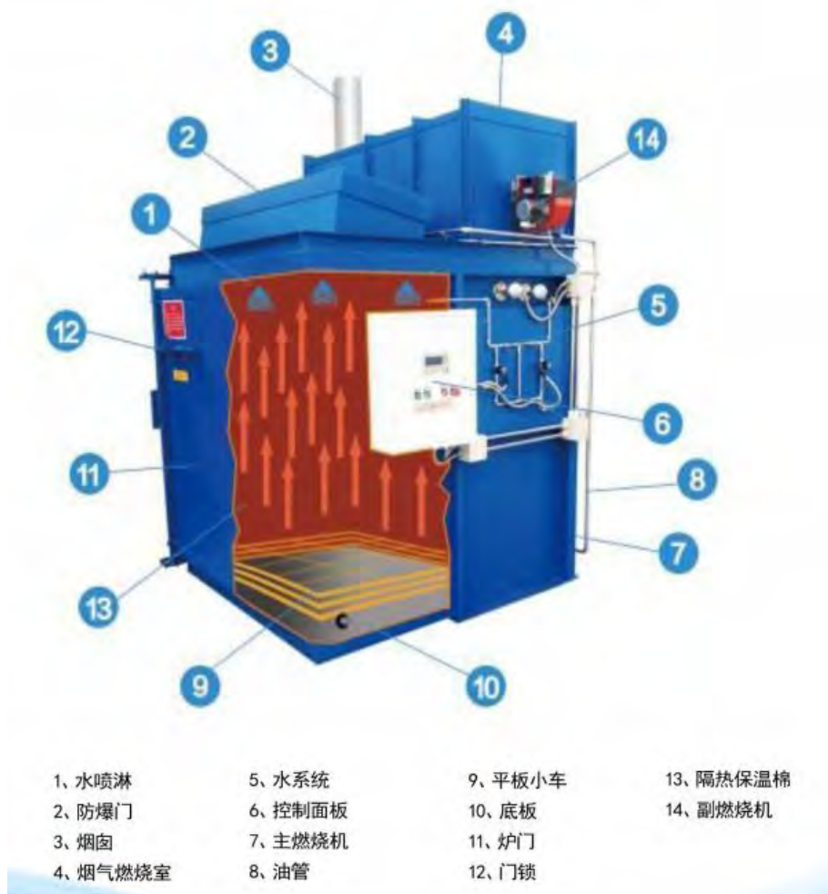
图 3-8 热洁炉内部构造图
