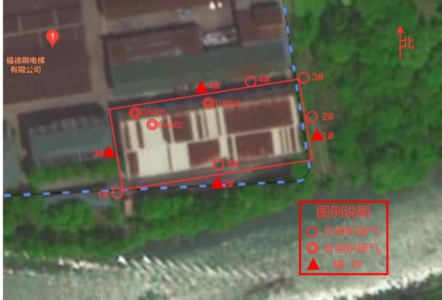
图 3-4 废气排放监控点和厂界环境噪声测点布置图
