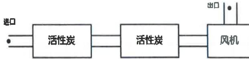
有组织废气 2#检测流程示意图:
