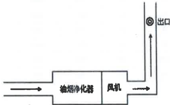
有组织废气 2#检测流程示意图:
