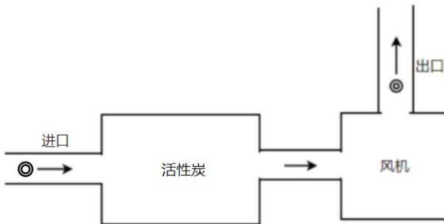
图3-2 有组织废气DA001流程图
