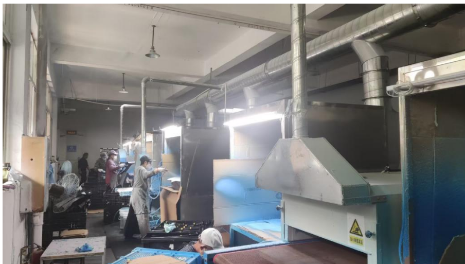
图 3-1 喷胶、烘干工段
