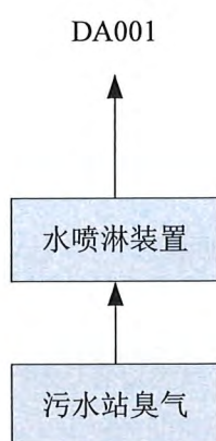
图 3-2 污水站臭气处理工艺简图
