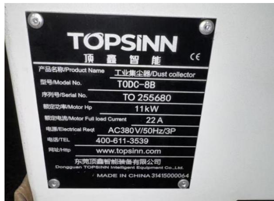
激光切板废气处理装置
