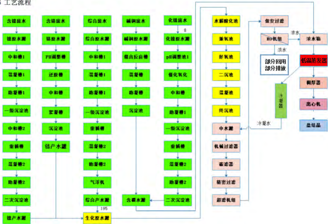
图 4.1-1 废水处理工艺流程图（镀铜、化学镍生产线未建设，对应的预处理设施未建设）
