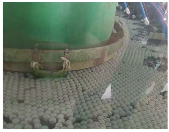
空心塑料球抑制废气的产生
