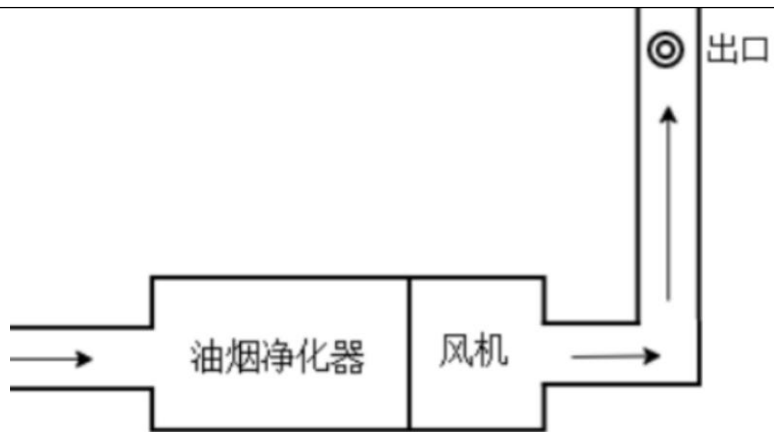
图 6-2 浙江欧盾液压技术有限公司有组织废气检测流程图
