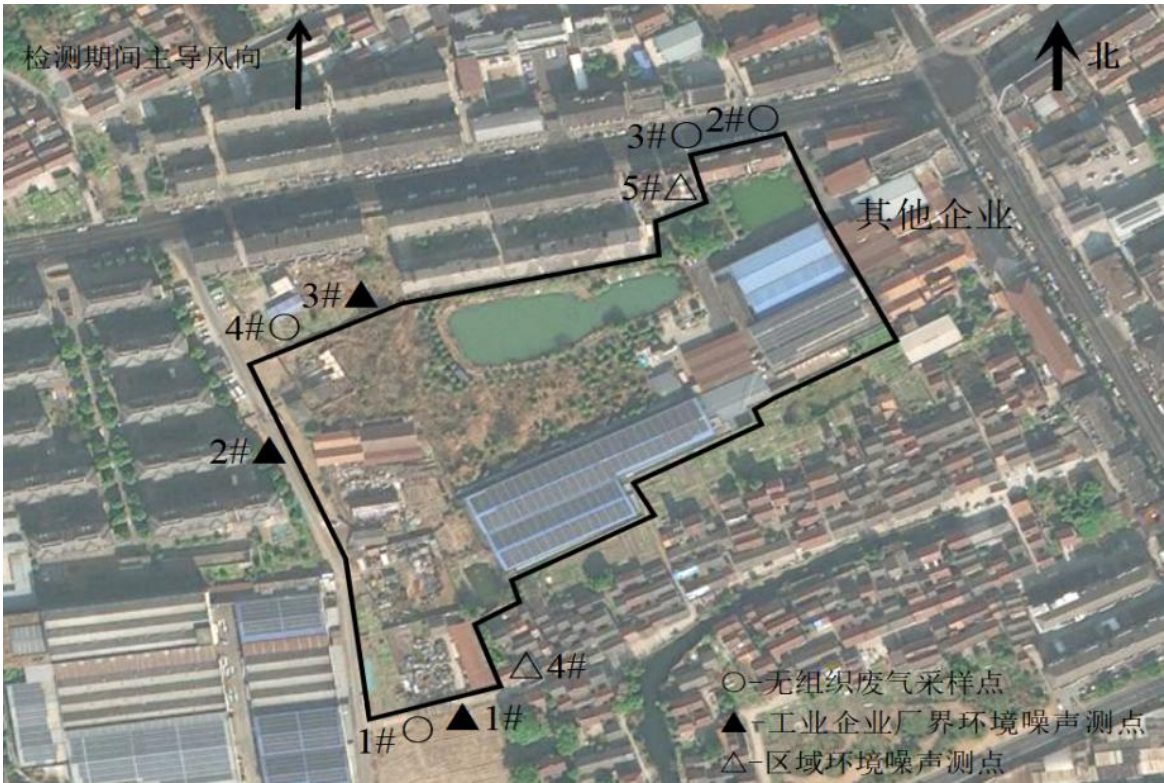
图 3-1 湖州市菱湖万事美毛纺织有限公司废气无组织排放监控点、废气有组织排放监控点、工业企业厂界环境噪声、综合废水排放监控点布置图
