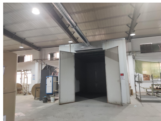
图3-4 高温热泵烘干机
